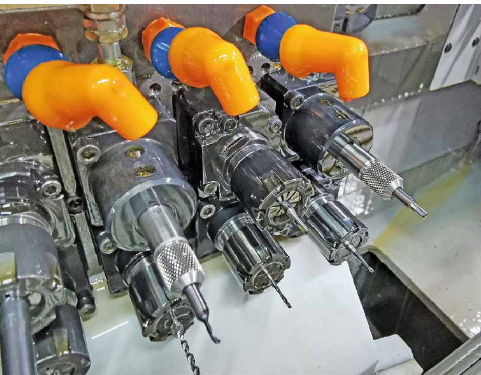
Die Hobe-Werkzeuge im Langdrehautomaten: Oben rechts ein Broachin-Stempel für das Stoßen eines Sechskant-Profils in einem Borin-Schnellwechselhalter, daneben ein angetriebener Tourin-Gewindewirbler und an dritter Position ein Hinterdrehwerkzeug.
