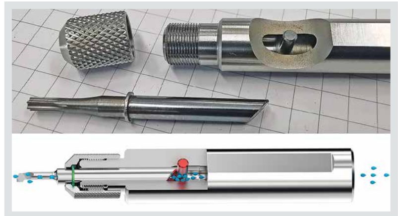
Beim Borin-Halter sichert die Schräge am hinteren Schaftende nach dem Anziehen der Rändelmutter die exakte Ausrichtung der axialen/radialen Lage. Wiederholgenauigkeit \pm 5 \mu\text{m} .
