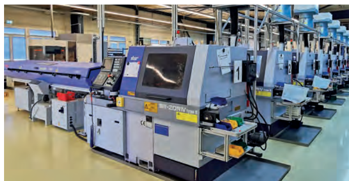
Die Produktion von metallischen Serienkomponenten erfolgt auf insgesamt zehn Langdrehautomaten.
